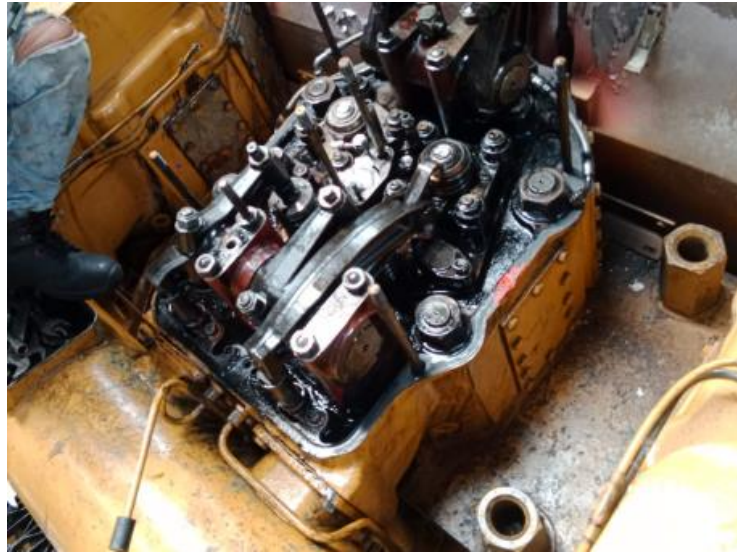
Gambar 2. 6 Overhole atau Inspection (OH) mesin Caterpillar
