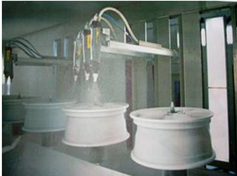
Gambar 2.35 : Proses Powder Coat
