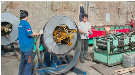
Gambar 2. 9 Pemasangan Coil Roll
