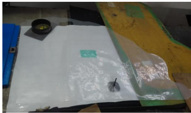
Gambar 2.3 Hasil Dari Proses Welder BZ 090
