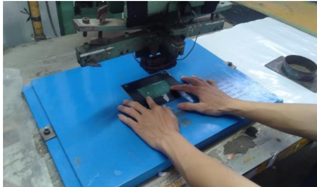
Gambar 2.5 Peletakkan Sub Sheet Green Pada Pola Jig Assy Welder
