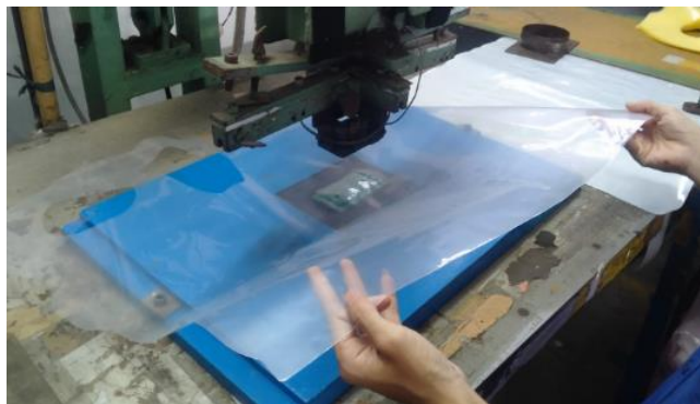
Gambar 2.8 Proses Pengangkatan Isolator
