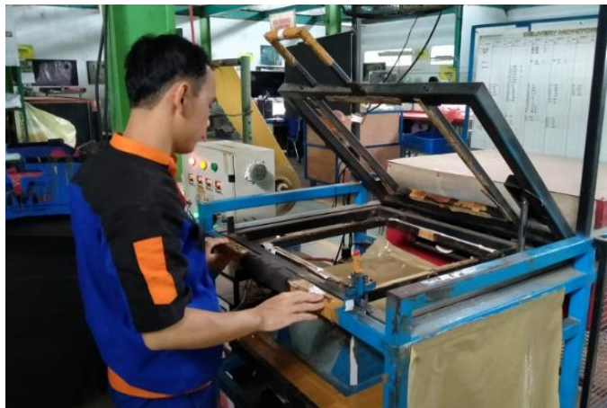
Gambar 2.15 Posisi Material Setelah Dibentuk Dengan Mesin Vacum
