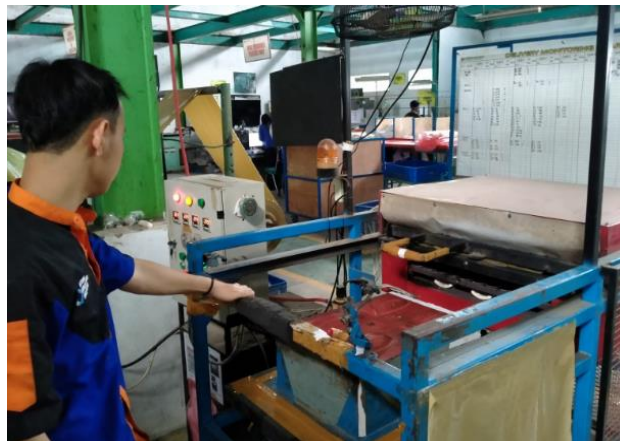
Gambar 2.13 Posisi Material Pada Saat Dimasukkan Ke Dalam Heater
