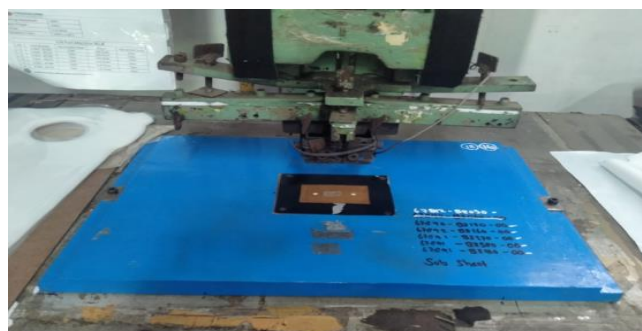
Gambar 2.4 Penyetingan jig Pada Alas Meja Assy Welder
