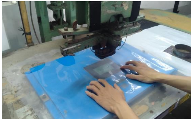
Gambar 2.6 Peletakan Main Sheet Pada Jig Assy Welder
