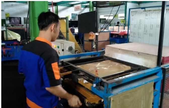
Gambar 2.14 Proses Pembentukan Material Yang Telah Dihisap oleh Mold Vacum
