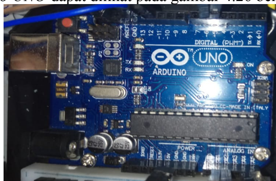
Gambar 4.50 Pemasangan Arduino UNO
