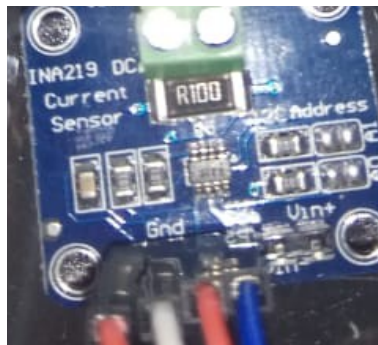
Gambar 4.37 Pemasangan sensor INA219
