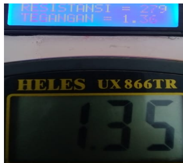
Gambar 4.44 Pengujian B sensor LDR terhadap alat ukur
