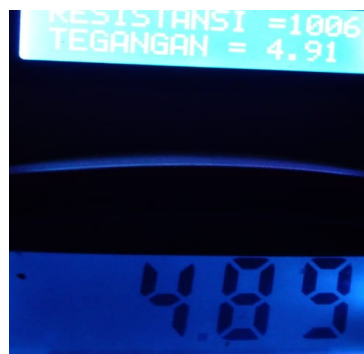
Gambar 4.45 Pengujian C sensor LDR terhadap alat ukur
