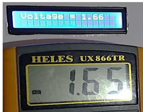
Gambar 4.34 Pengujian B sensor tegangan DC terhadap alat ukur multimeter
