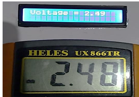
Gambar 4.33 Pengujian A sensor tegangan DC terhadap alat ukur multimeter
