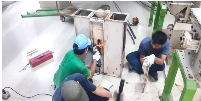
Gambar 2. 3. Proses Pemotongan Alur Modifikasi
