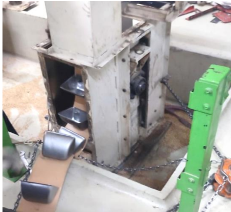
Gambar 2. 2 Melepaskan Dudukan Baut Boot Bucket Elevator
