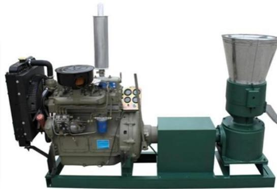
Gambar 2.2 Mesin Pelet
