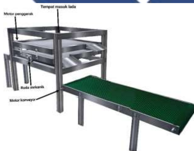
Gambar 3.2 Rancangan Alat Tampak Samping
