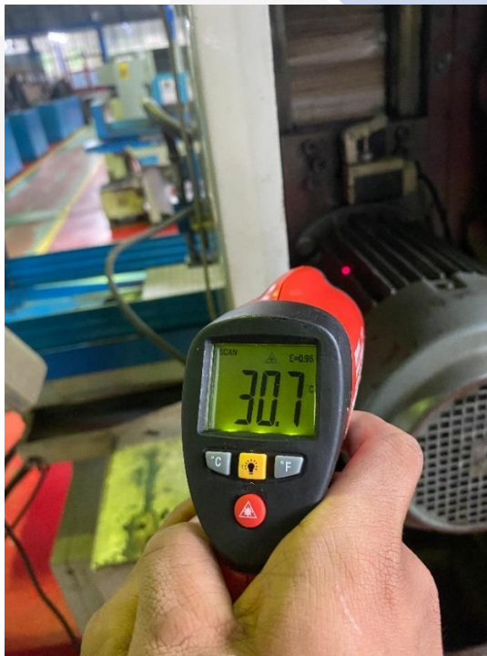
Gambar 4. 15 Pengecekan Suhu Motor Spindle
