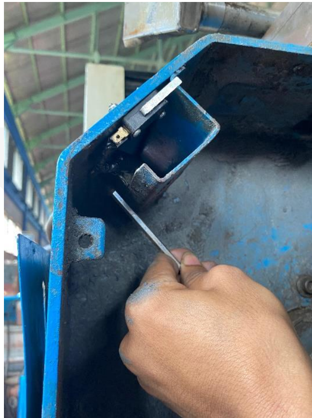
Gambar 4. 10 Proses Perbaikan Limit Switch
