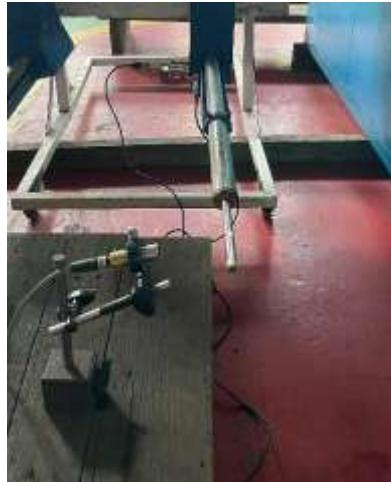
Gambar 4.12 Pemasangan sensor speed
