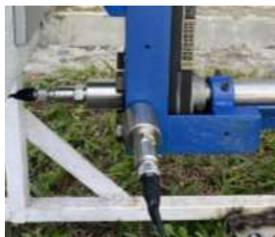
Gambar 4.11 Pengujian getaran pada pillow block bearing
