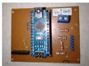
Gambar 4.17 Rangkaian Pada PCB
