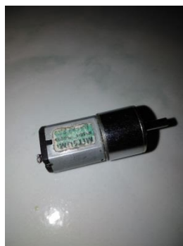
Gambar 4.32 Motor DC Sebagai Aktuator Pemetik
