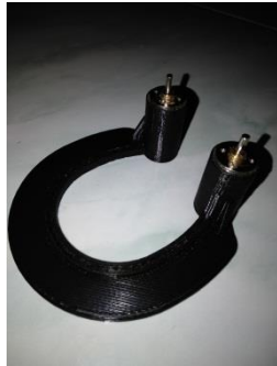
Gambar 4.33udukan untuk motor DC dan Pipa VPC
