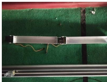
Gambar 4.29 Pemasangan Motor Servo di lengan 1 dan lengan 2
