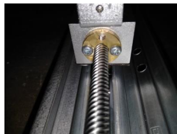
Gambar 4.23 Nut Housing dan Nut Brass yang digunakan sebagai pembawa lengan
