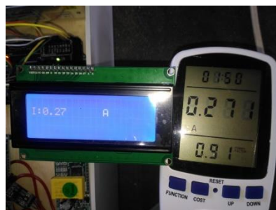
Gambar 4.18 Hasil pengujian arus
