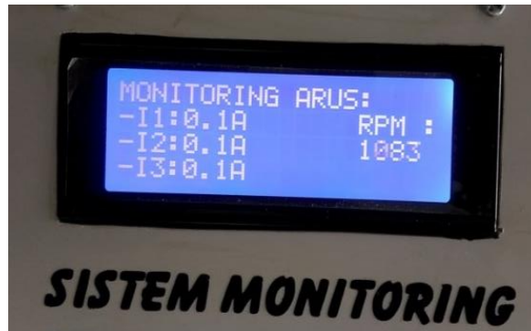
Gambar 4.22 Hasil Pengujian Arus
