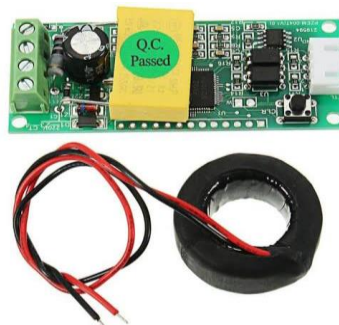
Gambar 4.5 Bentuk fisik AC digital multifunction meter PZEM-004T module [7]
