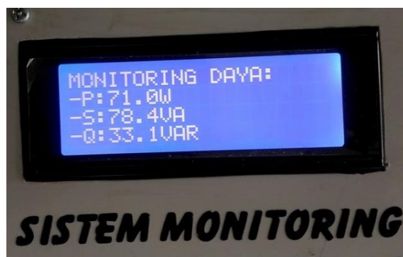
Gambar 4.24 Hasil pengujian daya
