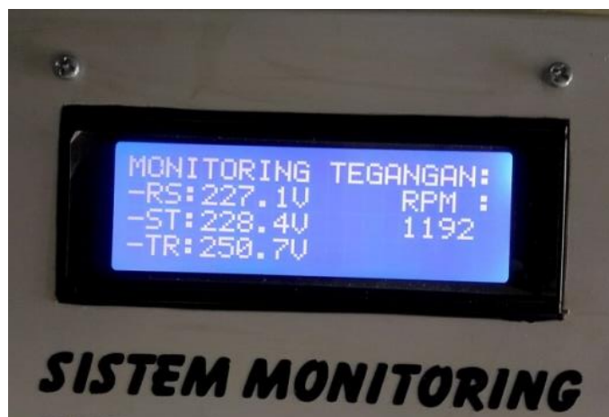
Gambar 4.21 Hasil pengujian tegangan dan rpm
