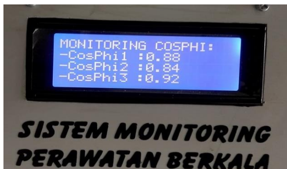
Gambar 4.23 Hasil pengujian cosphi
