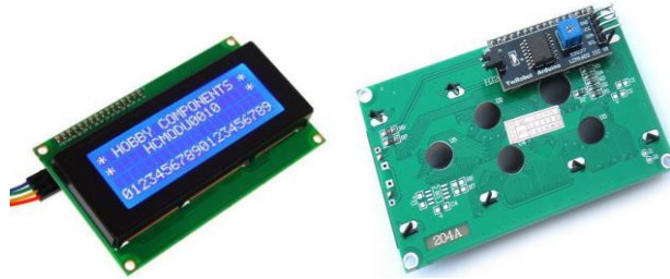
Gambar 4.9 LCD 20x4 dengan I 2 C [10]
