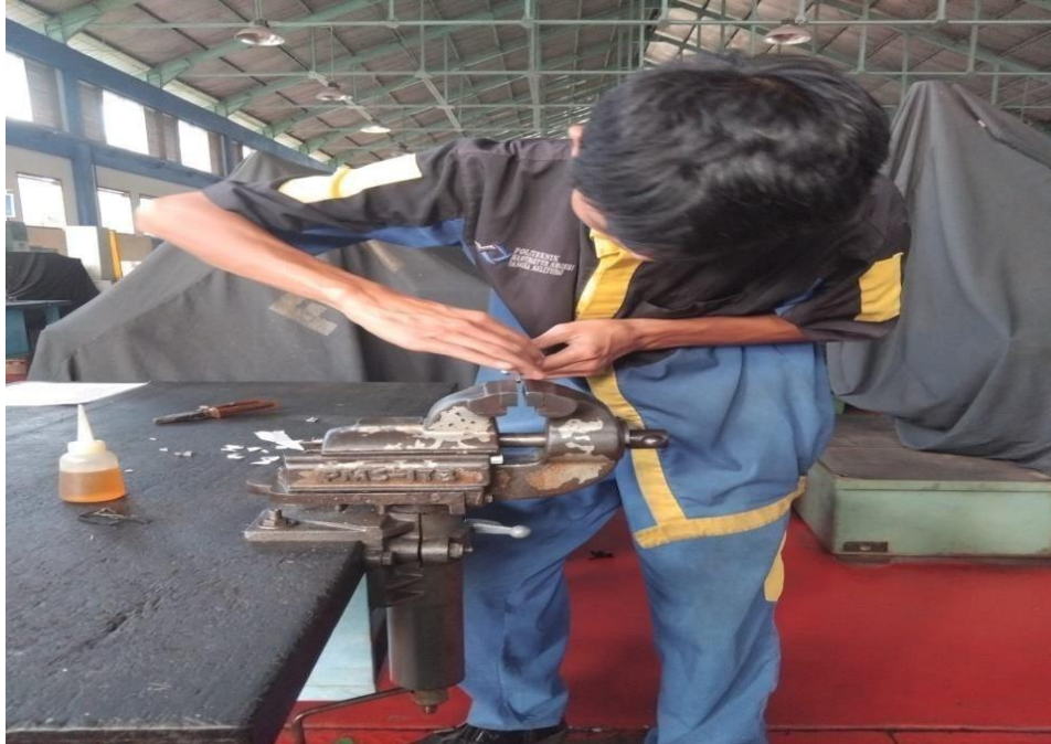
Foto melakukan proses ngetaps pada mata bor atau mata engraving
