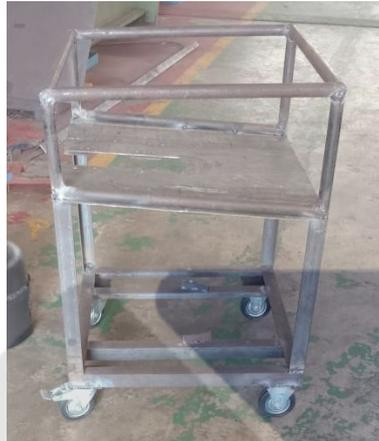
Gambar 4. 23 Proses Penyambungan Rangka
