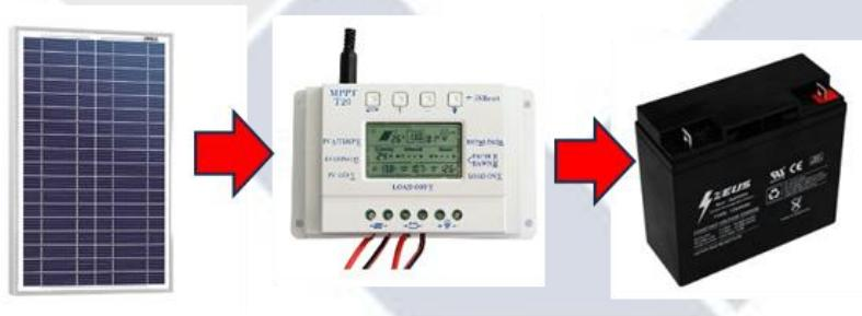
Gambar 4. 15 Pengisian Baterai Aki menggunakan *Solar cell* Cell
