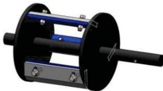
Gambar 2.3 Mekanisme Pencacah Tipe Gunting (Nuha D. A., dkk, 2018)
