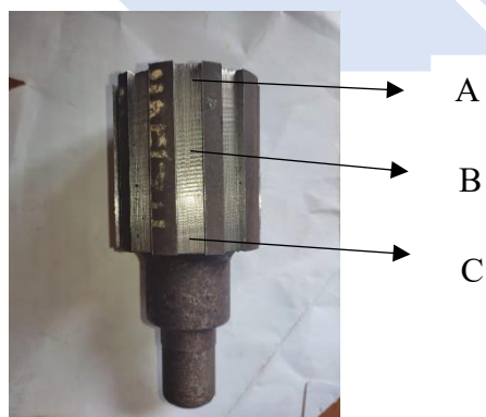
Gambar 4. 8 Benda Kerja Hasil Slotting
