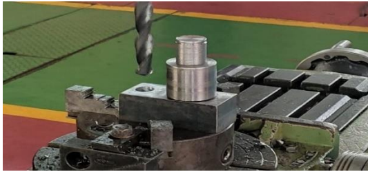
Gambar 4. 4 Proses Pembuatan Shaft Eccentric
