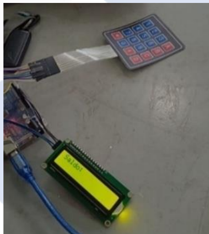
Gambar 4. 11 Hasil Dari Skematik Rangkaian Keypad 4x4
