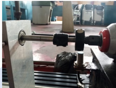
Gambar 4. 10 Pemasangan kopling fleksible
