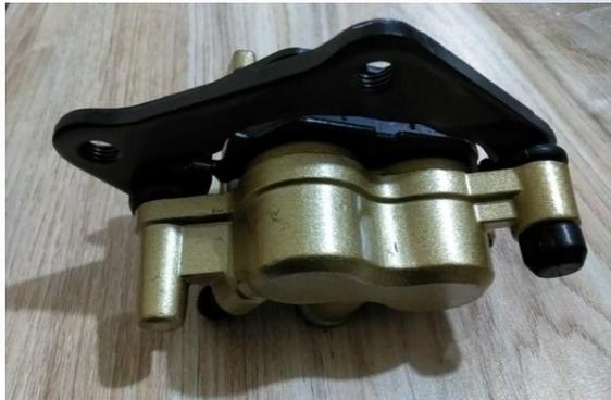
Gambar 4. 1 *Caliper* motor Vixion
