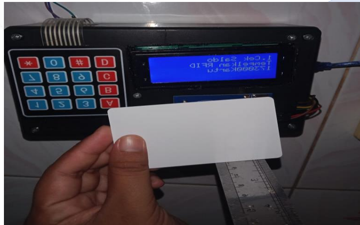
Gambar 4. 3 Pengujian Jarak Kartu ke Sensor RFID
