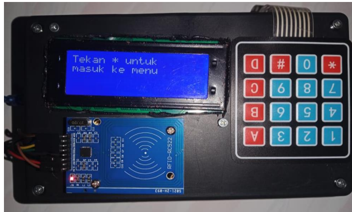
Gambar 4. 2 Pengujian Keypad dan LCD 20 x 4 i2c
