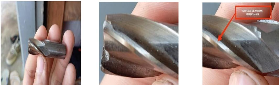
Gambar 1. 1 Sisi Bagian Yang Dilakukan Pengasahan
