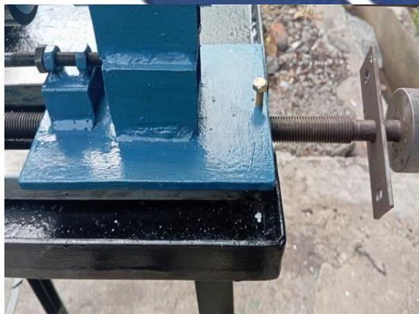
Gambar 4. 17 Pemasangan Eretan Pada Landasan Eretan
