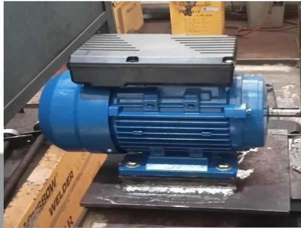
Gambar 4. 18 Pemasangan Motor Listrik Pada Dudukan Eretan
