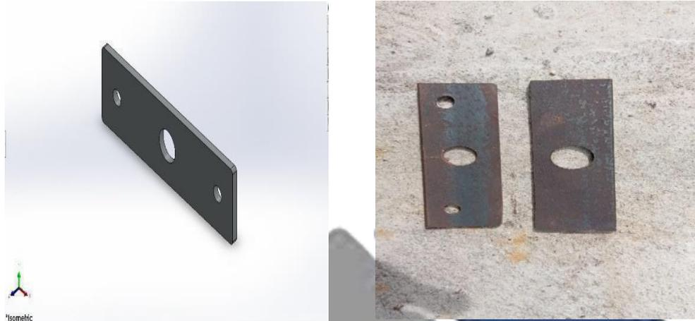
Gambar 4. 11 Pembuatan *Braked* atau Penyangga Eretan
