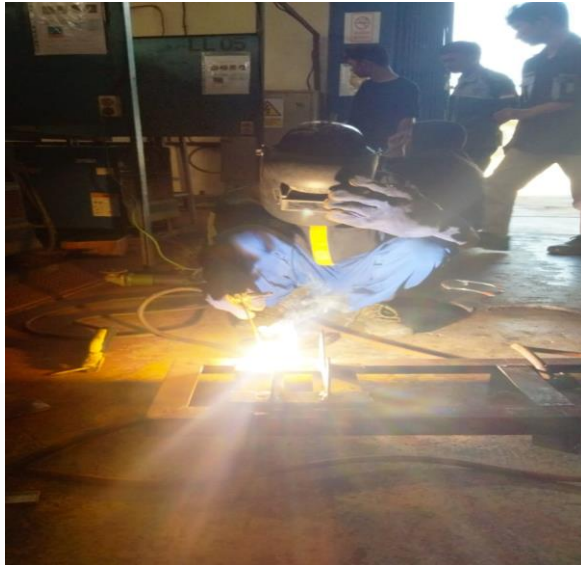
Gambar 4.16 Proses Las Listrik
