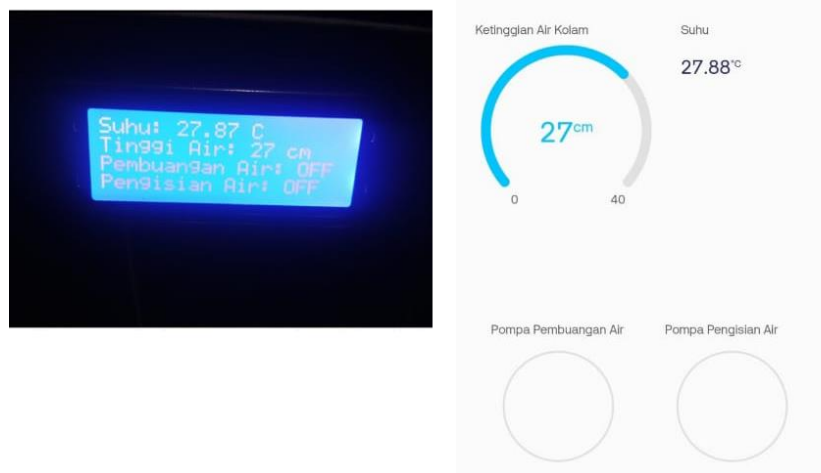
Gambar 4. 18 Tampilan Keseluruhan Pada LCD dan Aplikasi Blynk
