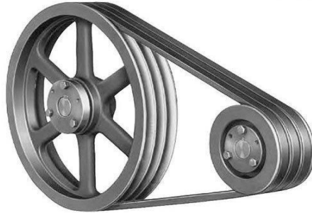
Gambar 2. 7 Sabuk V dan Pulley
