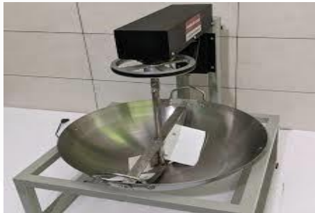
Gambar 2. 3 Proses Pengaduk Dodol Mekanis
