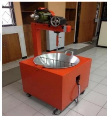
Gambar 1. 5 Alat Pengaduk Dodol Semi Otomatis Kapasitas 5 kg.
