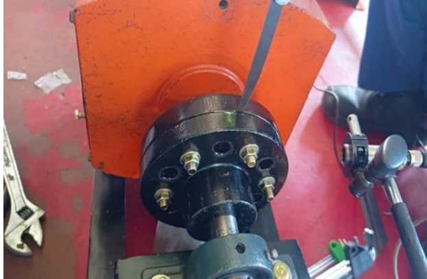
Gambar 3. 12 Angular Misalignment Posisi Vertikal
