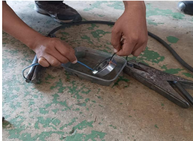
Gambar 3. 14 Proses Perusakan Bantalan Pada Bagian Outer Ring Dan Inner Ring
