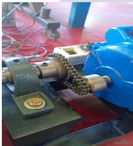
Gambar 3. 6 Sprocket Penghubung Motor Listrik Dengan Poros Utama
