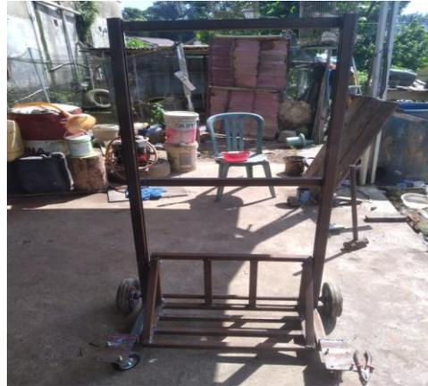
Gambar 4. 11 Perakitan Kontruksi Rangka Dan Kontruksi Landasan
