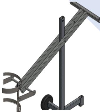
Mekanisme pengangkatan pesawat sederhana berupa sistem tuas yang terdiri dari titik tumpu di tengah. Cara penggunaannya letakkan galon di atas platform troli. Sistem tuas digunakan untuk menggerakkan platform ke atas: saat salah satu ujung tuas ditekan ke bawah, tuas akan mendorong ujung lainnya karena sistem ini bekerja melalui tuas yang memiliki titik tumpu di tengahnya.
