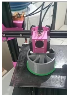
Gambar 3. 5 Proses Manufaktur Komponen Waterjet Thruster
