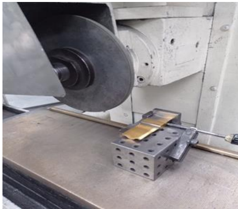
Gambar 2. 17 Proses grinding pembuatan slot punch
