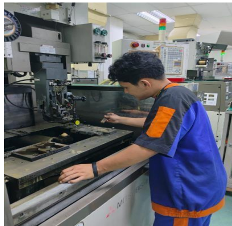
Gambar 2. 4 Proses setting pada mesin wire cut
