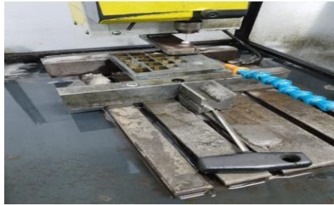
Gambar 2. 7 Material yang telah memiliki hole dari mesin Super drill
