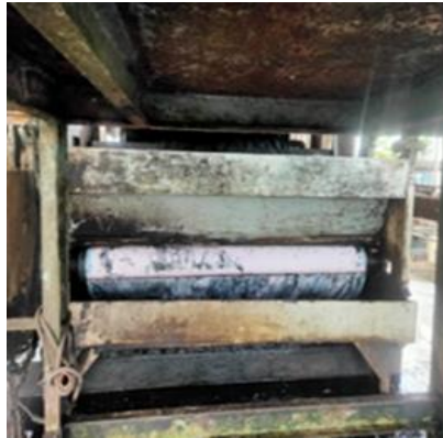
Gambar 2. 14 Penggantian Mesh Mesin Belt Press
