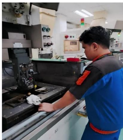
**Gambar 2. 4** Proses *setting* pada mesin *wire cut*
