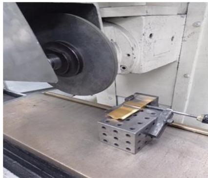
**Gambar 2. 17** Proses *grinding* pembuatan *slot punch*
