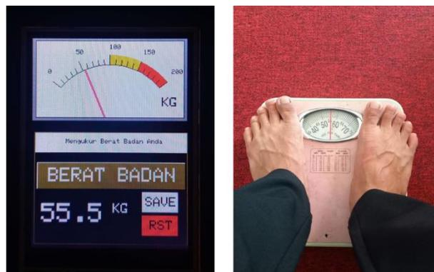
Gambar 4.13 Pengujian Alat Ukur Berat Badan
