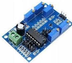
Gambar 2.1 Modul IC ICL8038
