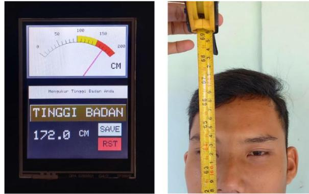
Gambar 4.15 Pengujian Alat Ukur Tinggi Badan
