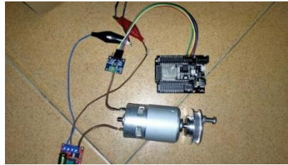
Gambar 4.21 Uji Coba Sensor INA219
