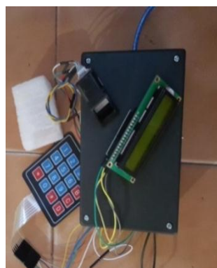
Gambar 4.16 Perakitan Komponen Didalam Box
