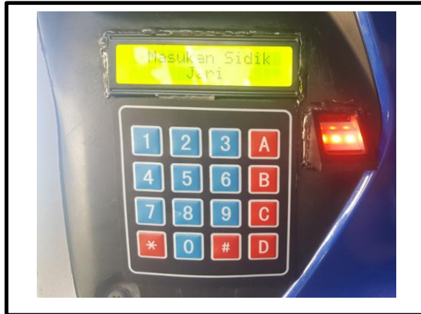
Gambar 4.2 Desain Peletakan Alat Pada Motor
