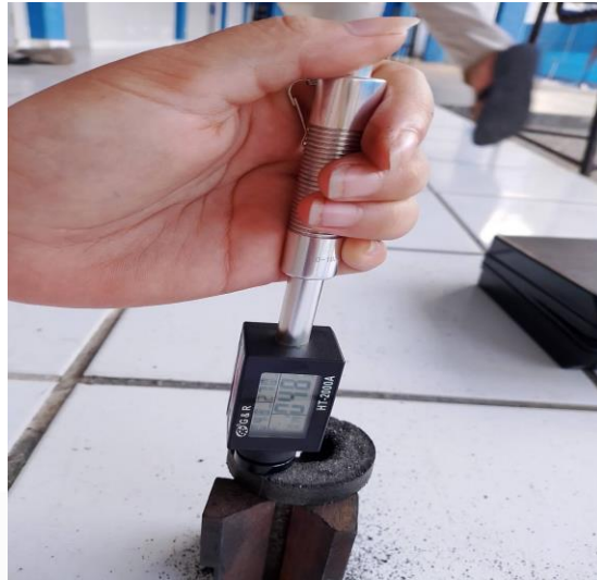
Gambar 4.11 Proses pengujian kekerasan setelah proses sintering dengan menggunakan alat uji kekerasan portabel satuan HB dilakukan di Lab Material Polman Babel.
