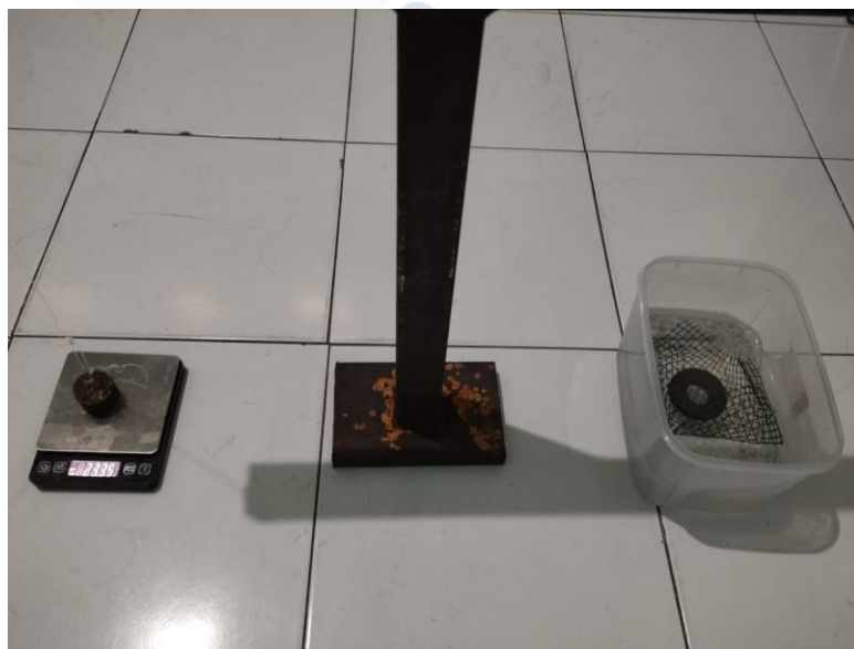
Gambar 4.9 Proses penimbangan basah pada sampel menggunakan alat timbang yang berpedoman pada hukum Archimedes .
