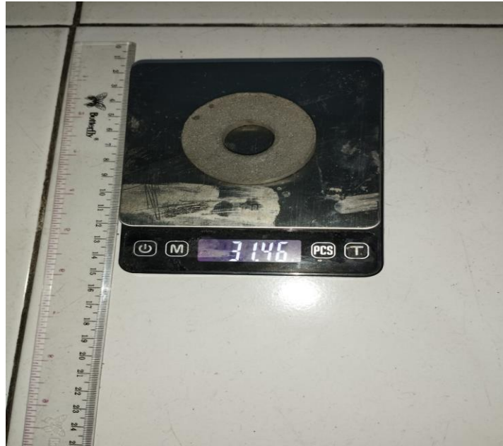
Gambar 4.8 Proses timbangan kering pada sampel menggunakan timbangan digital.
