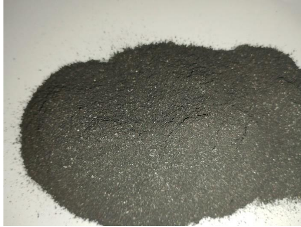
Gambar 4.1 Serbuk hasil proses pencampuran dan pemaduan mekanik (mixing) dengan menggunakan mesin ball mill selama 2 jam.
