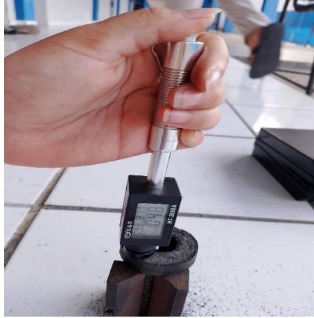
Gambar 4.6 proses pengujian kekerasan pada sampel menggunakan alat uji kekerasan portable dengan satuan HRB.
