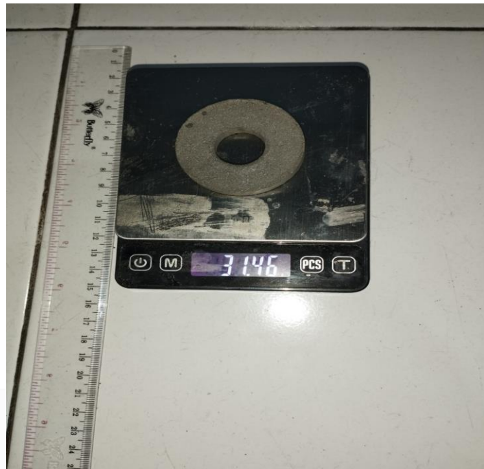
Gambar 4.14 Proses penimbangan sampel dalam kondisi kering setelah proses sintering
