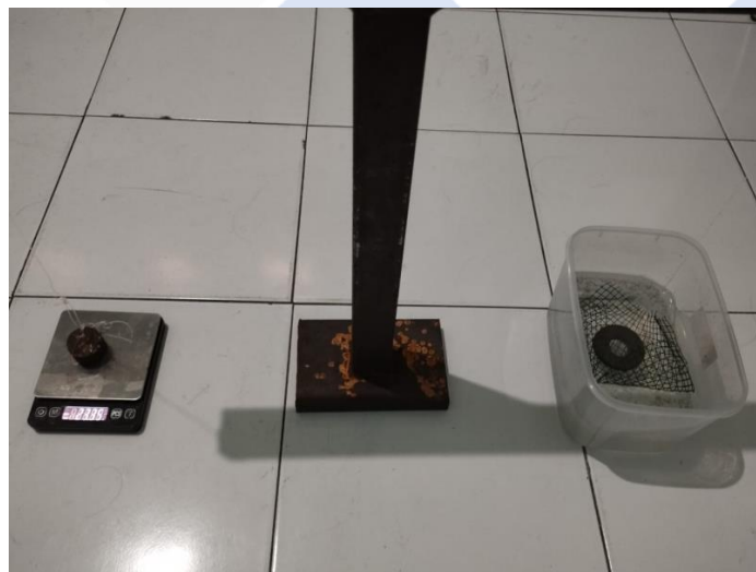
Gambar 4.15 Proses penimbangan sampel dalam kondisi basah dengan memasukkan sampel kedalam air sesuai dengan hukum Archimedes.
