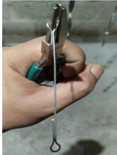
Gambar 1.2 Bending kawat menggunakan tang loop
