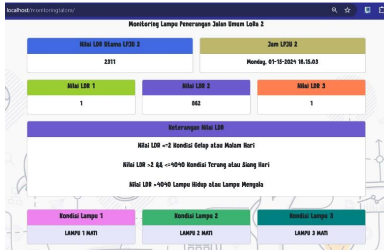
Gambar 4. 10 Tampilan Sistem Monitoring Pada LPJU 2
