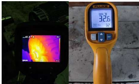
Gambar 2.5 Proses Pengecekan suhu/temperatur menggunakan alat thermal imaging (flir/termogan)
