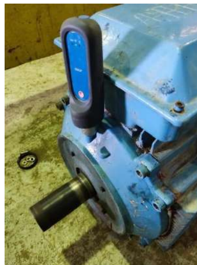
Gambar 2.4 Proses Pengecekan getaran menggunakan vibrasi (SKF)
