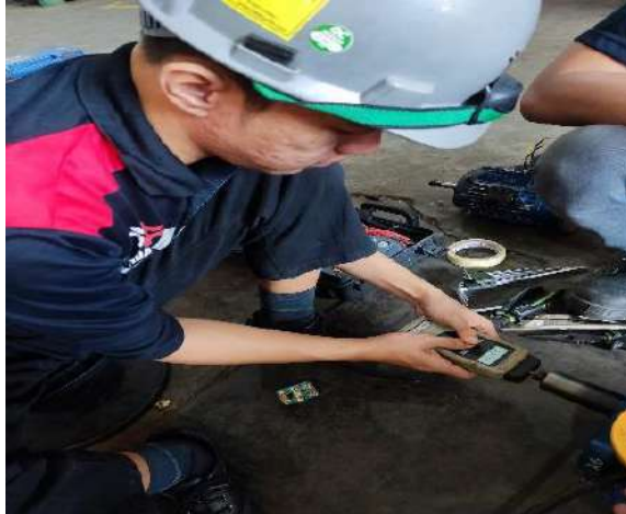
Gambar 2.6 Proses Pengukuran Tachometer
