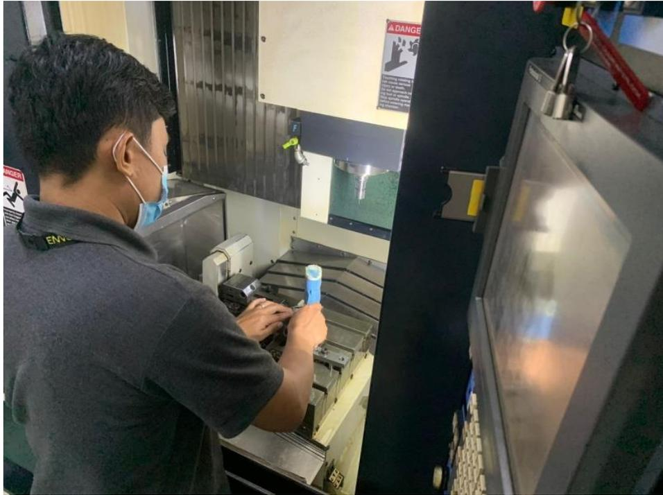
**Gambar 2.10 Pemasangan Benda pada wise**
