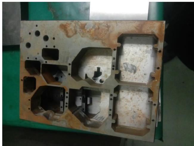
**Gambar 2.1** Material yang dilakukan proses wirecut dalam membuat *die insert*
