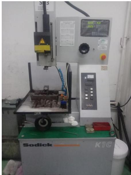
**Gambar 2.4 Mesin Superdrill**
