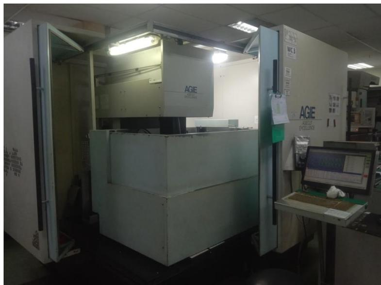
**Gambar 2.13 Mesin Wirecut Agie**
