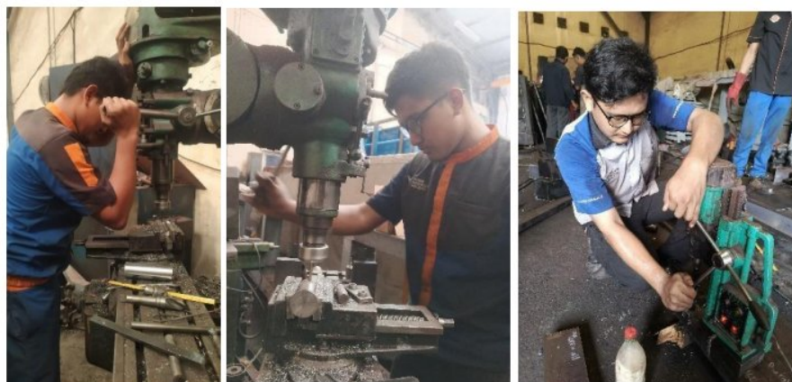
Gambar 2.4. Pengoprasian Mesin Milling(Frais) dan Bor Magnet
