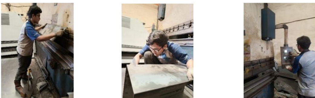
Gambar 2.2 Pengoprasian Mesin Bending Plat
