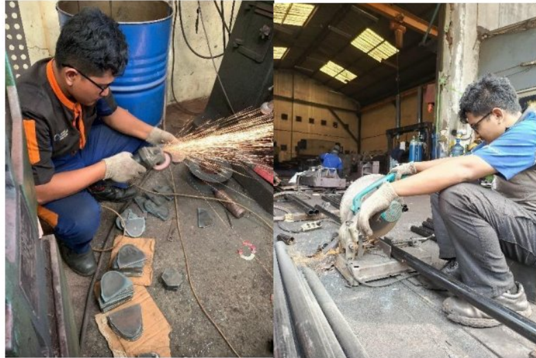
Gambar 2.5. Pengoprasian Mesin Gerinda Tangan dan Gerinda Cutting wheel
