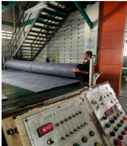
Gambar 2. 4 Pemindahan felto yang telah sesuai ukuran
