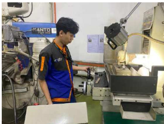
Gambar 2. 14 Proses sherp en mata potong Tooling
