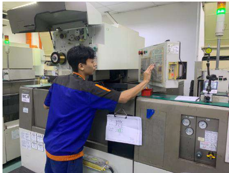
Gambar 2. 1 Proses Setting pada Mesin wirecut
