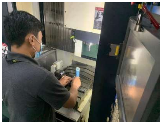
Gambar 2. 13 Pemasangan benda pada wise
