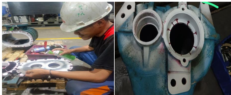
Gambar 2.1 Proses NDT PT & Indikasi Crack
