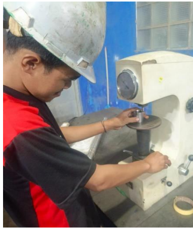
Gambar 2.7 Pengujian Kekerasan Benda Kerja
