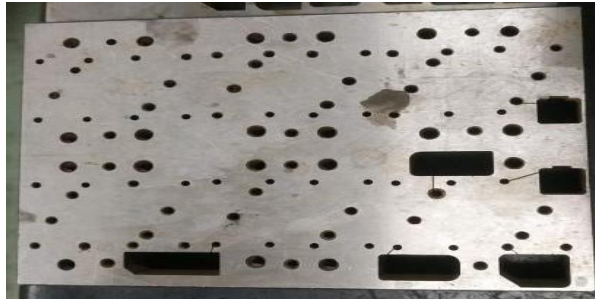
Gambar 2.6 Material yang siap di proses pada mesin wire cut
