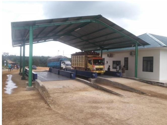
Gambar 1. 4 Jembatan Timbangan (Sumber : PT. MAS, 2024)
