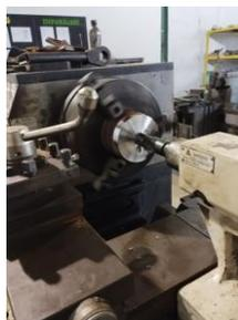
Gambar 2.8 membubut konde sprocket
