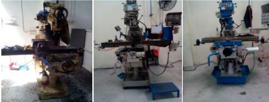
Gambar 1. 5 Mesin *Frais* atau *Milling*
