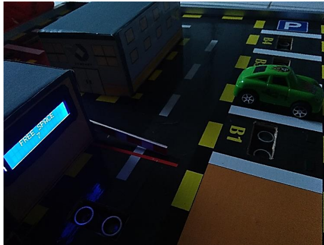
Gambar 4. 17 Pengujian sensor ultrasonik dengan LCD
