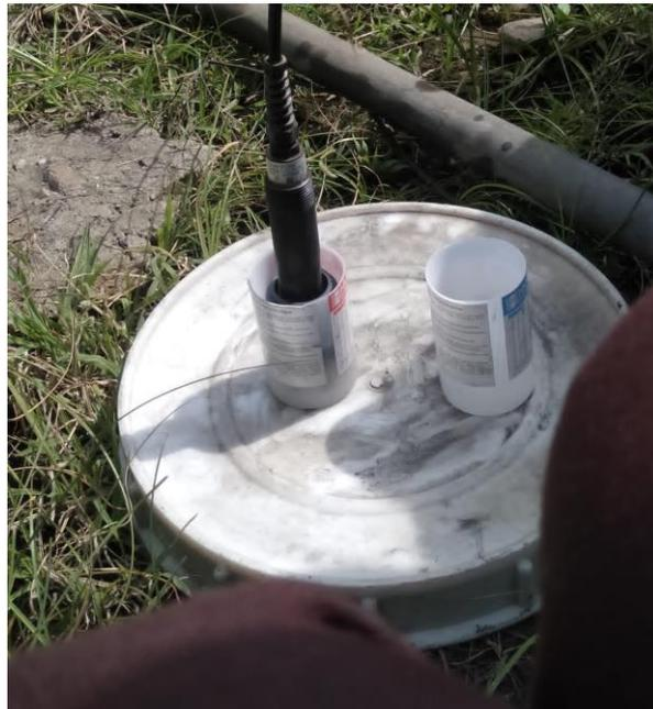
*Gambar 2. 4 Kalibrasi Sensor PH*
