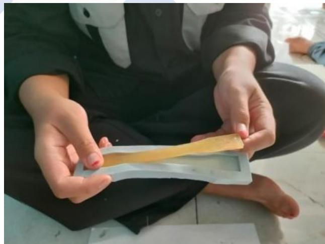
Gambar 3.28 Hasil mencetak sampel uji tarik
