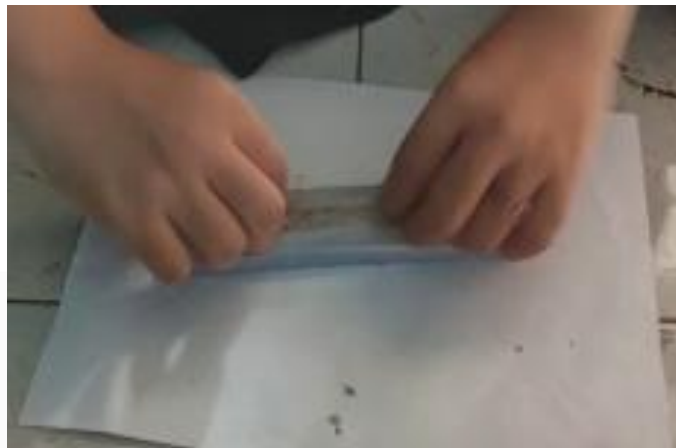
Gambar 3.23 Penyusunan serat sampel uji tarik
