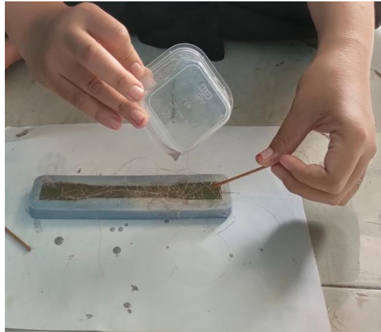
Gambar 3.25 proses mencetak sampel komposit
