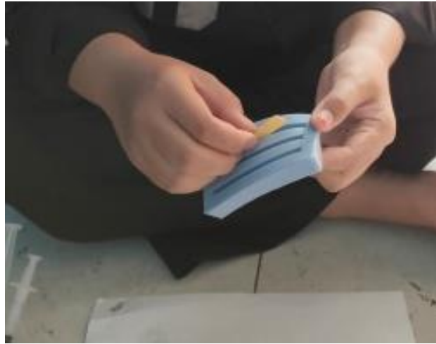
Gambar 3.29 Hasil mencetak sampel uji impact
